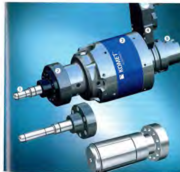
Bild: Systemaufbau eines Xstep®KT-Honwerkzeugs mit KomTronic® U-Achse; 1 Modularer Adapter mit Xstep® Honwerkzeug 2 DIHART DAH® Ausgleichhalter mit Ring zur Korrektur des Rundlaufs und der Winkellage 3 KomTronic® U-Achse mit Stellmotor zur Ansteuerung des Honwerkzeuges 4 Stator zur Energie- und Datenübertragung 5 mögliche Schnittstellen: HSK-A63, HSK-A100, ISO40, ISO50, BT40, BT50, CAT40, CAT50 und PSC (Werkbild: Komet Group GmbH, Basiglio)
